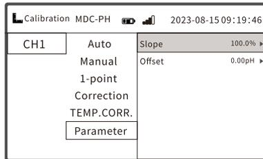
Fig.44 Calibration parameter setting
